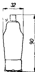
Encombrement du tube EBC 3. Fig. 5
