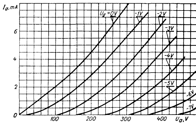
I_a = f(U_a) (каждого триода) (for each triode) U_h = 6,3 \text{ V}
